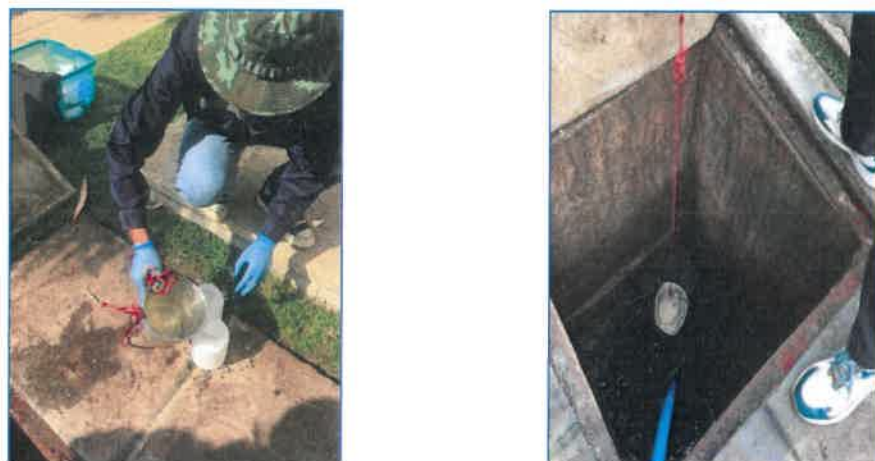
บ่อตรวจคุณภาพน้ำหลังผ่านระบบบำบัด
