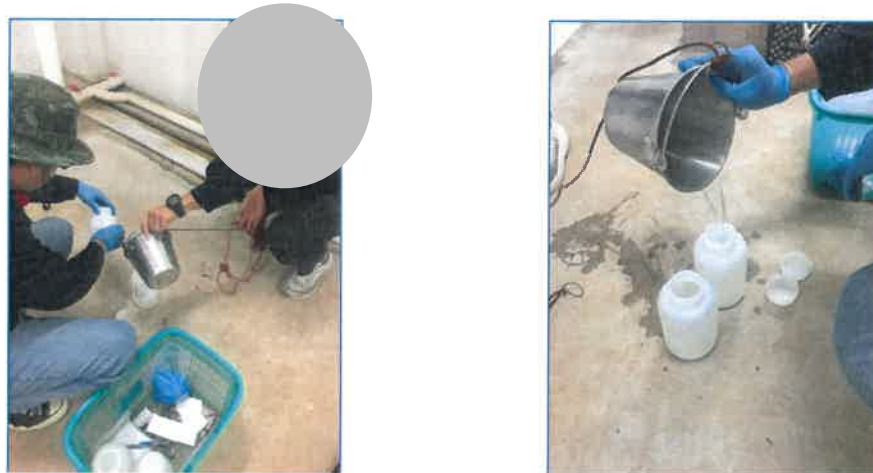
บ่อตรวจคุณภาพน้ำก่อนเข้าระบบบำบัด
